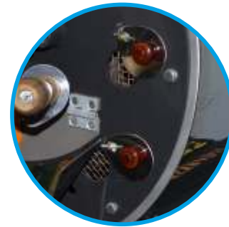
Вентиляционные лючки с заслонкой
